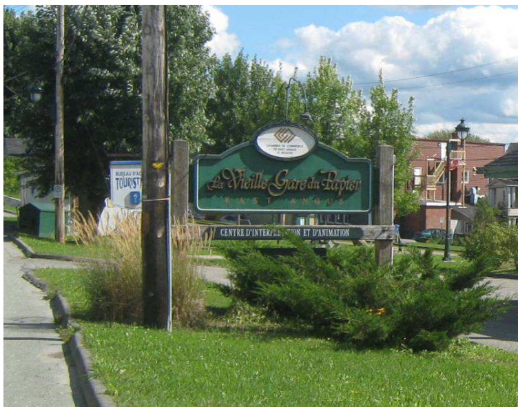
LES SUPPORTS D'ENSEIGNE DOIVENT ÊTRE IMPLANTÉS SUR UNE SURFACE DÉLIMITÉE POURVUE D'UN AMÉNAGEMENT PAYSAGER À LA BASE. ÉVITER LES BASES PLEINES OU MONOLITHIQUES
