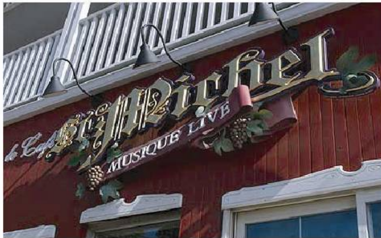
L'ENSEIGNE DOIT ÊTRE LOCALISÉE DE MANIÈRE À NE PAS MASQUER LES DÉTAILS ARCHITECTURAUX DU BÂTIMENT (MOULURATION, OUVERTURE, ETC.)
